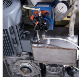
Yağ geri dönüşüm sistemi Yağ tüketimini azaltır. Kartuş filtresi ve düşük seviye uyarısı ile donatılmıştır. Dış dolgu.
